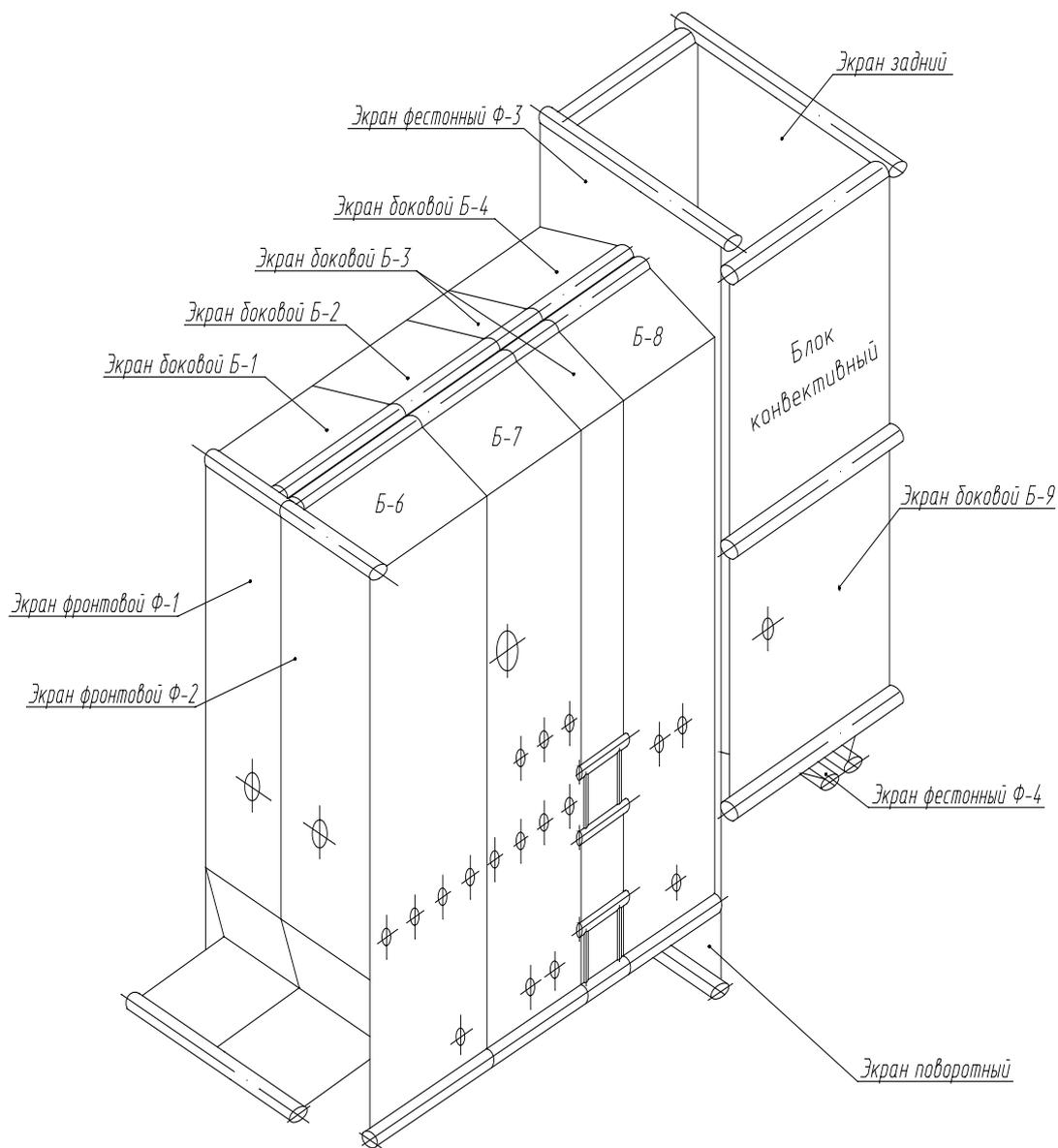
Схема расположения экранов котла
