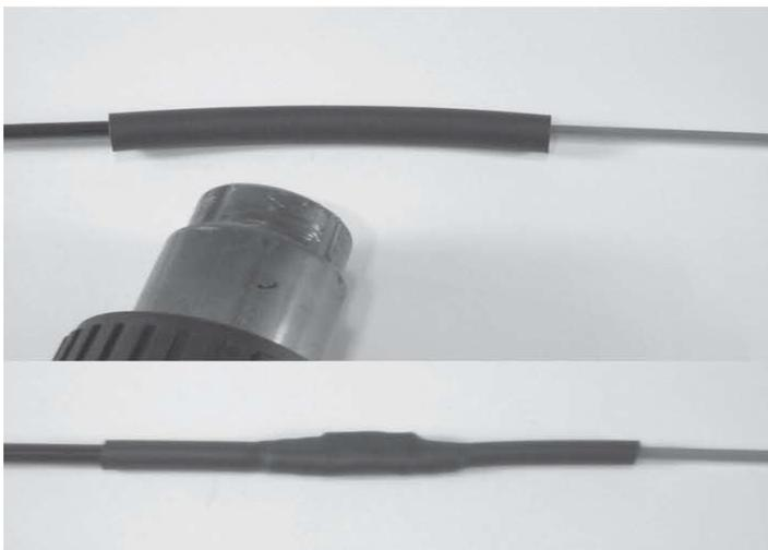
Надвиньте среднюю трубку 8/2, 100 мм на место соединения. Отцентрируйте ее и усадите при помощи термофена, начиная усадку от середины и постепенно передвигаясь к концам.
