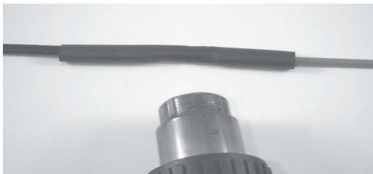
Надвиньте на место соединения большую термоусаживаемую трубку 9/3, 130 мм и усадите ее, начиная с середины и постепенно передвигаясь к концам.
