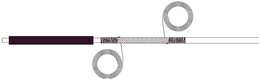
7. Натяните большую термоусаживаемую трубку A поверх экрана так, чтобы она перекрывала одинаковые расстояния внешней изоляции нагревательного кабеля и холодного конца.
