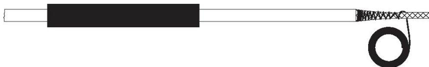
13. Наденьте среднюю термоусаживаемую трубку В поверх медного экрана и нагрейте ее при помощи термофена (температура примерно 200 С). Сожмите свободный конец трубки так, чтобы получить герметичное соединение и проследите, что из трубки вышел весь воздух, а на другом конце трубки показалось некоторое количество клея.
