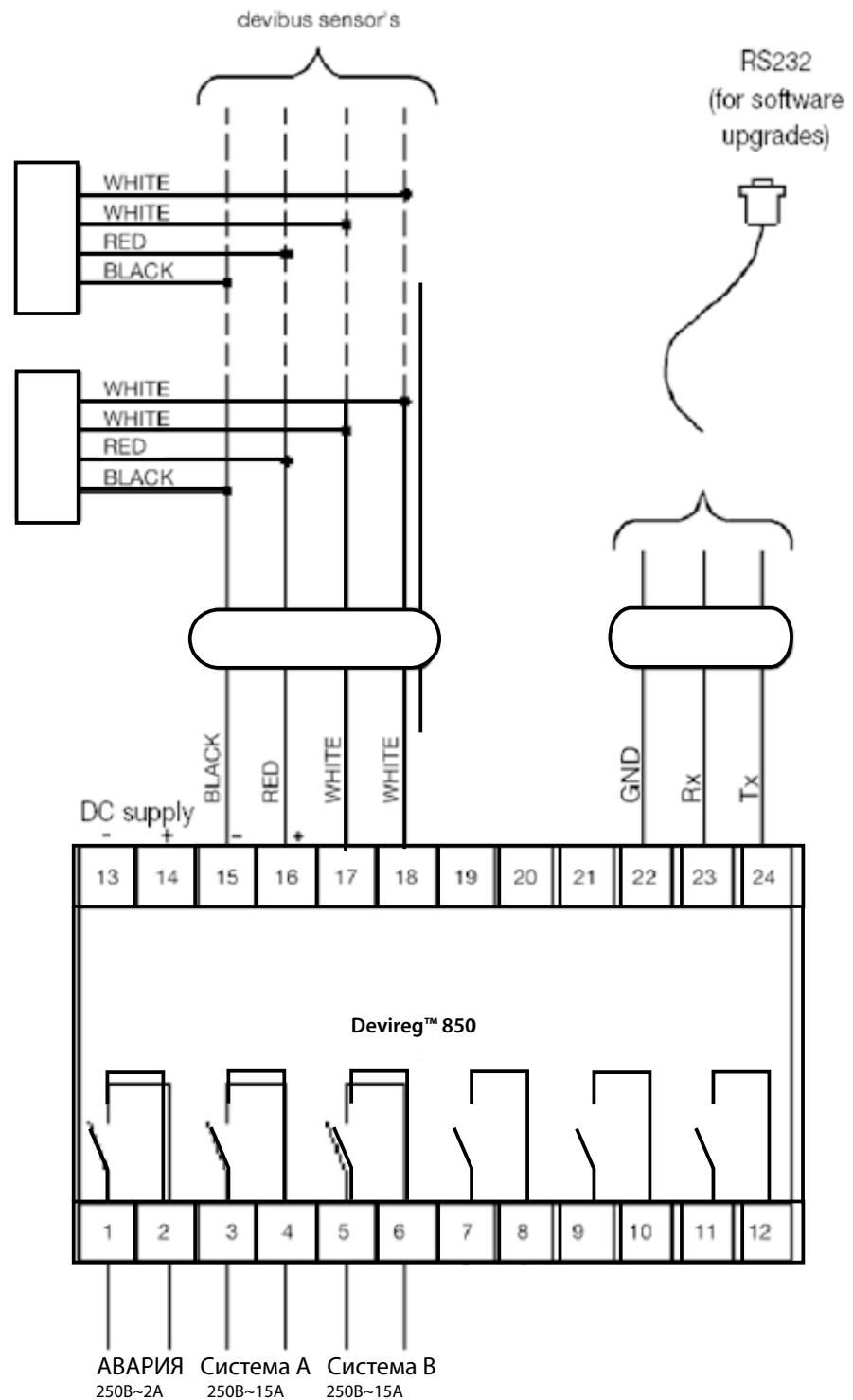
Devireg™ 850 имеет встроенную систему аварийной сигнализации, которая анализирует исправность подсоединеных датчиков и работу микропроцессора самого блока Devireg™ 850. К контактам 1-2 можно также подсоединить внешнюю систему сигнализации.
