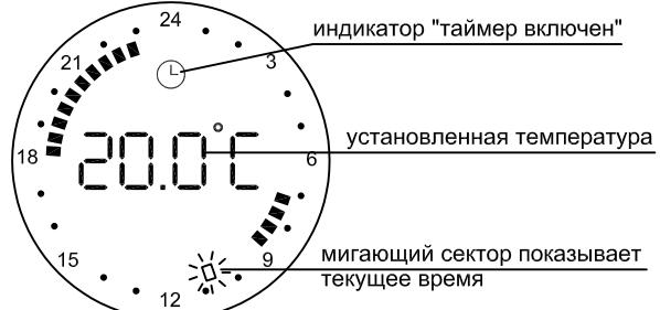
Уже теперь вы можете включить терморегулятор в работу. Система "теплый пол" работает следующим образом : с помощью ручки управления регулятора вы устанавливаете необходимое значение температуры на экране, а терморегулятор будет поддерживать это значение, включая и выключая нагревательный кабель .
