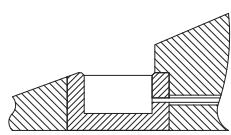
На наклонных поверхностях датчик должен быть установлен горизонтально
