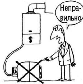
7. Используйте только газовые редукторы на 30 мбар (300 мм водяного столба) (никогда не используйте редукторы 50 мбар (500 мм водяного столба)).
