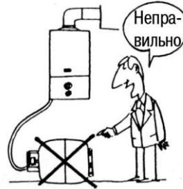
7. Используйте только газовые редукторы на 30 мбар (300 мм водяного столба) (никогда не используйте редукторы 50 мбар (500 мм водяного столба)).
