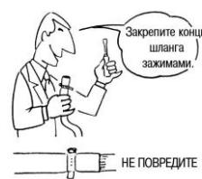
8. При использовании сжиженного газа длина соединительного шланга не должна превышать 125 см. Соединительный шланг должен быть закреплен хомутами в местах подсоединения. Следите за тем, чтобы хомуты не повредили шланг.
