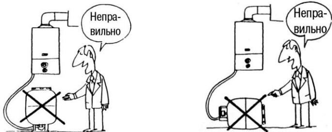
7. Используйте только газовые редукторы на 30 мбар (300 мм водяного столба) (никогда не используйте редукторы 50 мбар (500 мм водяного столба)).
