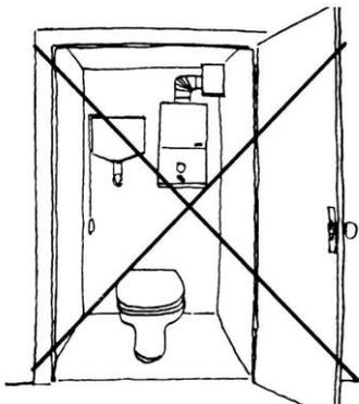
5. Категорически не рекомендуется устанавливать водонагреватель в помещениях объёмом менее 6 м<sup>3</sup> или с площадью пола менее 2,5 м<sup>2</sup>.
