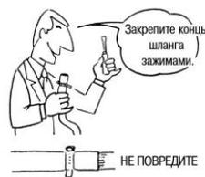
9. Перед началом работы водонагревателя необходимо удостовериться в отсутствии утечки газа в местах подсоединения и по всей длине соединительного шланга. Для этой цели можно использовать только мыльную воду или специальную пенящуюся жидкость. Никогда не осуществляйте контроль утечки при помощи открытого пламени.
