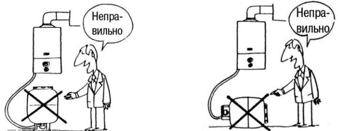
7. Используйте только газовые редукторы на 30 мбар (300 мм водяного столба) (никогда не используйте редукторы 50 мбар (500 мм водяного столба)).
