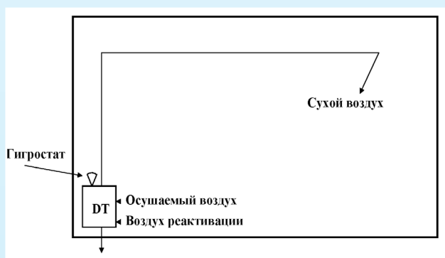
Установка в подвальном помещении
