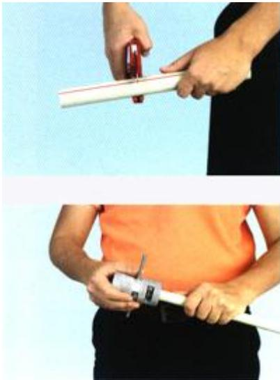
3. Отмерить и отрезать трубу необходимой длины при помощи необходимого инструмента. Обработать торец трубы фаскоснимателем для лучшей сварки.
