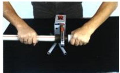
б. Нагрев детали согласно времени сварки снимем детали с насадок и медленными движениями без круговых движений насадить детали друг на друга. Необходимо выждать время охлаждения согласно нижеприведённой таблицы. При условии соблюдения правил гарантировано надёжное соединение.
