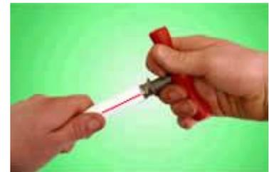
Этот процесс облегчает монтаж фитинга, предохраняет резиновые уплотнительные кольца от повреждения, тем самым, повышая надежность и герметичность соединения. Для упрощения работы можно снять рукоятку с развертки, и вставить развертку в патрон электродрели
