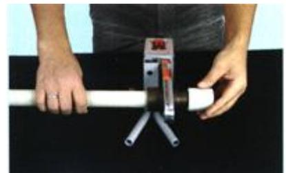
5. Обе части необходимо нагреть согласно таблице сварки труб и фитингов. Время нагревания считается со времени, когда детали полностью надеты на насадку. Во время нагревания труба и фитинг должны быть неподвижными.
