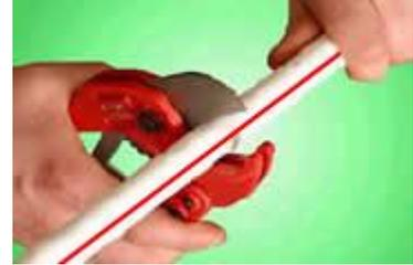
**2.** При отрезании возможно возникновение деформации на срезе и заужение внутреннего диаметра края трубы, что в свою очередь затрудняет насадку фитинга на трубу. Для этого, с помощью развертки-калибратора откалибруйте край трубы и снимите фаску, не менее 2 мм в глубину, на внутренней поверхности трубы. Фаска снимается ножами, расположенными у основания развертки.
