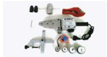
Тефлоновые насадки на сварочный аппарат (диаметр насадок 16-20-25-32, артикулы 66 613170, 66 613990, 66 613210, 66 613230) ;
