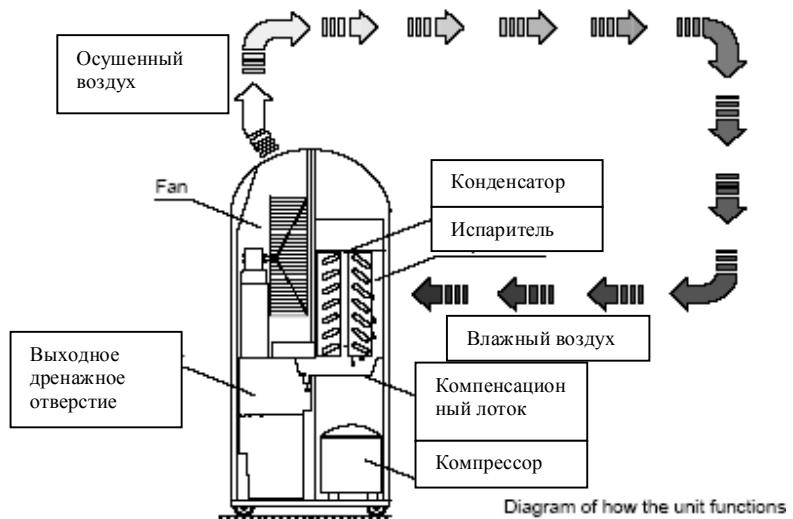
Осушенный, охлажденный воздух вновь нагревается в **конденсаторе** (радиаторе), а затем выводится наружу с температурой примерно на 5 градусов выше комнатной температуры. Этот воздух, который теперь стал суще, вновь смешивается с окружающим воздухом. Относительная влажность воздуха постепенно сокращается до желаемого значения относительной влажности, с помощью непрерывной циркуляции внешнего воздуха через установку.
