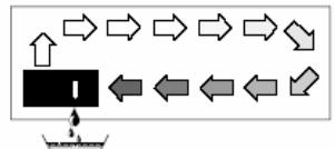
Поток воздуха охлаждается по пути сквозь/через испаритель-конденсатор, пока его температура не опускается ниже температуры точки росы. Водяной пар конденсируется и собирается в конденсационном лотке и дренируется.
