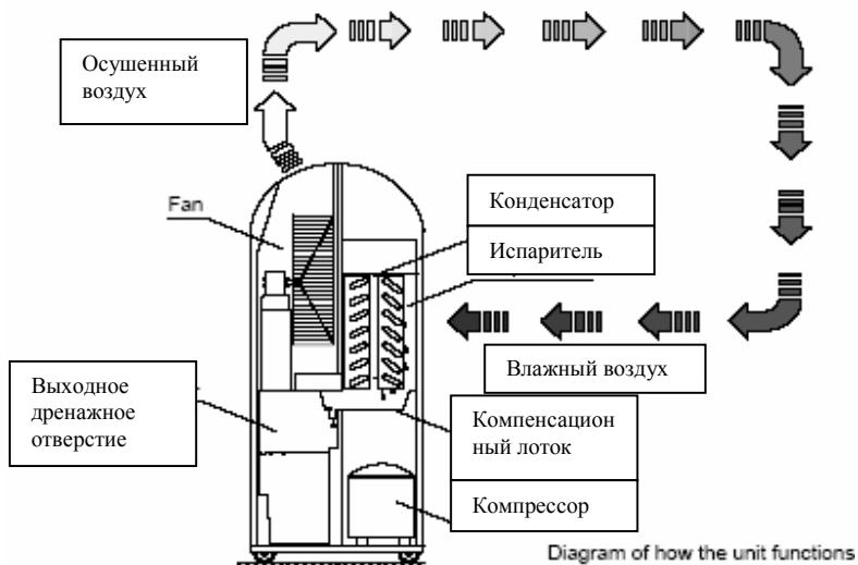
Осушенный, охлажденный воздух вновь разогревается в **конденсаторе** (радиаторе), а затем выводится наружу с температурой примерно на 5 градусов выше комнатной температуры. Этот воздух, который теперь стал сухим, вновь смешивается с окружающим воздухом. Относительная влажность воздуха постепенно сокращается до желательного значения относительной влажности, с помощью непрерывной циркуляции внешнего воздуха через установку.
