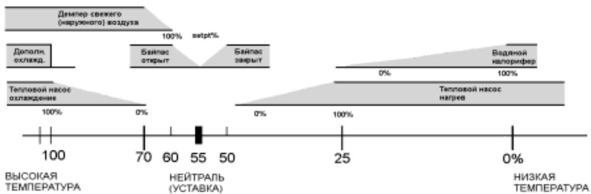
**Рис.2.1.** Потребность помещения в нагреве и охлаждении регулируется в пределах от 0 до 100%. Компоненты вентиляционного агрегата управляются в показанной последовательности.
