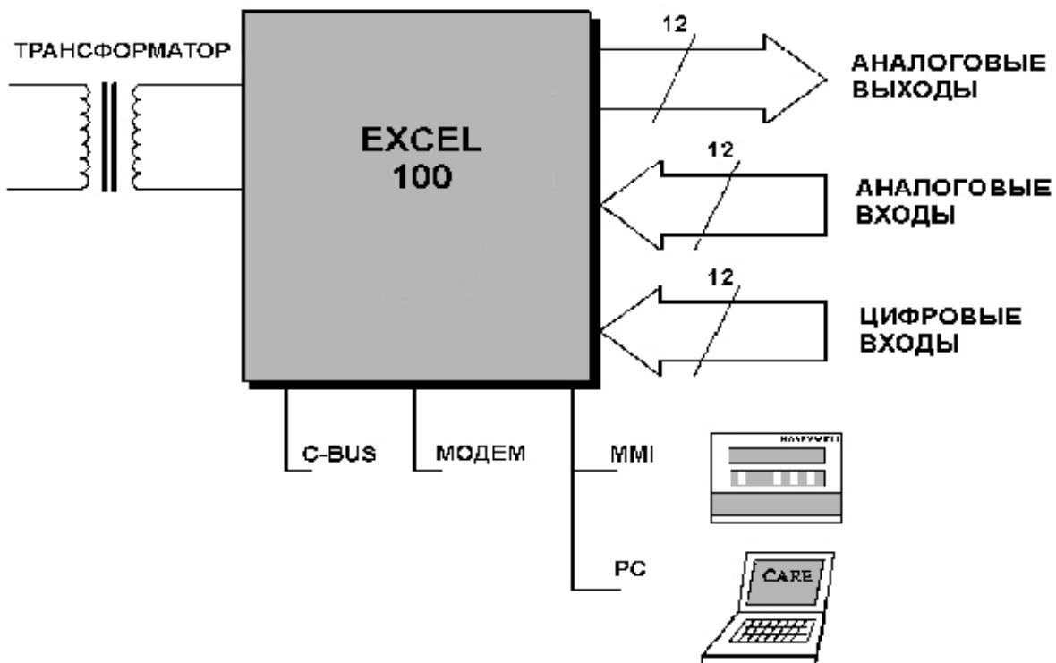
Рис.3.1. Схема внешних соединений контроллера EXCEL 100.
