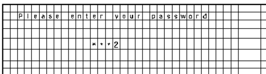
Переход к следующей цифре осуществляется однократным нажатием кнопки ВПРАВО и с последующим нажатием кнопок ВВЕРХ и ВНИЗ для выбора требуемого числа.
