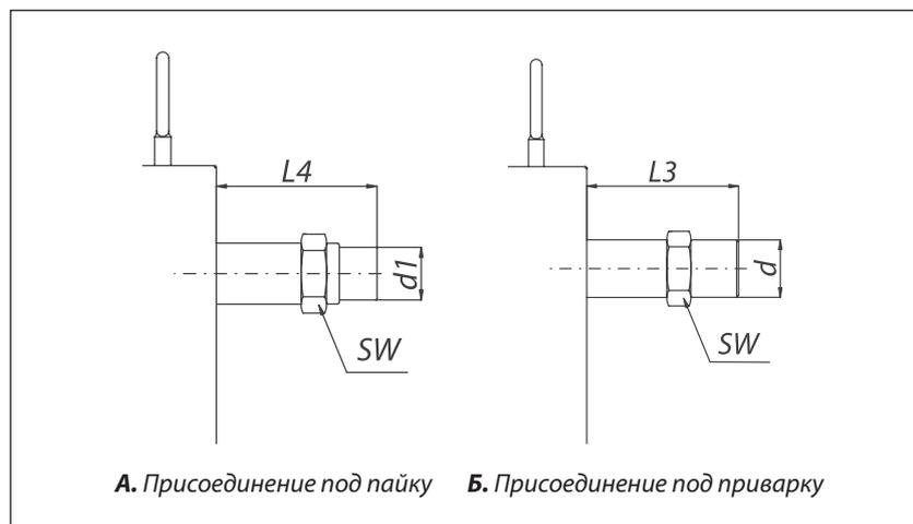
Присоединительные размеры фитингов для разборных пластинчатых теплообменников серии XG
