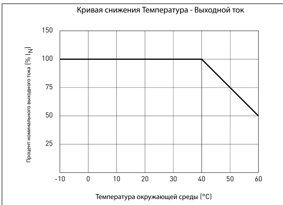
Рисунок 5. Кривая температура-снижение параметров выходного тока.
