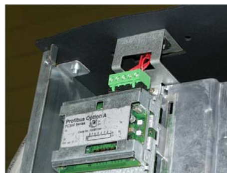
Рисунок 3.53: Подключение шины сети fieldbus сверху.
