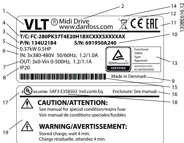
Рисунок 3.1 Паспортная табличка изделия (пример)
