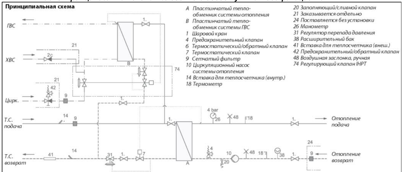
Рис. 7. Принципиальная схема малого теплового пункта модификации Termix VVX-I
