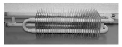
Установить на сварочном пистолете ACCU-TWIN расстояние между захватами 19 мм, приварить шпильки M3 x 8 на калач конвектора таким образом, чтобы верхняя находилась на расстоянии 10 мм от начала патрубка ближе к терморегулирующему клапану.
