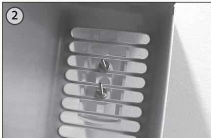
*Зафиксировать платформу на решетке кожуха с помощью двух широких гаек М3.*
