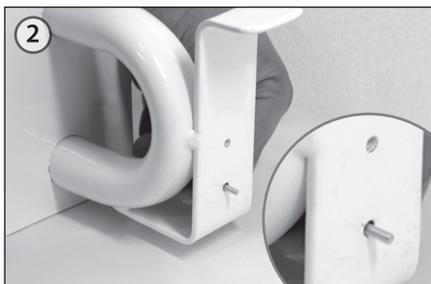
2. Вернуть установочной винт М4 х 8 в нижнее отверстие на кронштейне для крепления счетчика-распределителя тепла таким образом, чтобы снаружи оставалось 3 мм.
