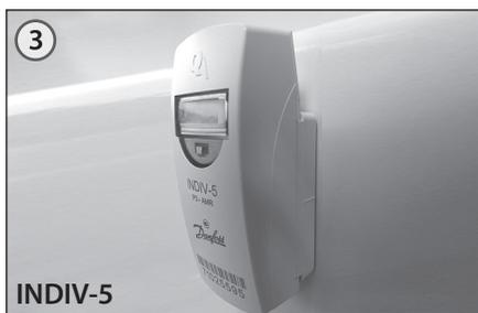
При монтаже счетчика-распределителя тепла INDIV-5 с визуальным считыванием показаний защелкнуть корпус счетчика на платформе для крепления счетчика-распределителя.
