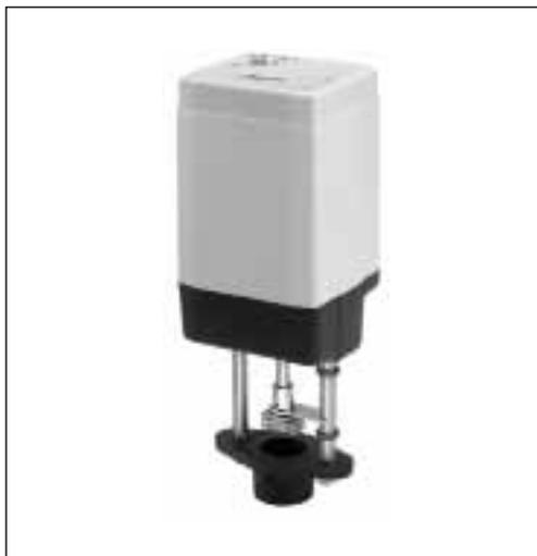
Электропривод AME 55 QM предназначен для работы с большими комбинированными регулирующими клапанами АВ-QM  $D_v = 125-150$  мм. Привод автоматически подстраивается под ход штока клапана, сокращая время ввода регулирующего органа в эксплуатацию.
