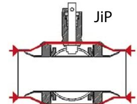
Таким образом шаровый кран JiP легко и надежно закрывается и открывается при самых тяжелых условиях работы.
