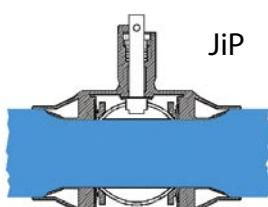
► **Минимальное гидравлическое сопротивление среди аналогов со стандартным проходом за счет оптимальной формы проточной части (плавные конусные переходы на входе и на выходе, а также цилиндрическая вставка в отверстии шара при  $D_y$  выше 80 мм).**
