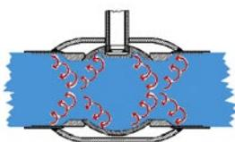
► **Уникальная самообжимная конструкция уплотнений шара обеспечивает полную долговременную герметичность и оптимальный крутящий момент в условиях высоких температур, давлений и термомеханических нагрузок со стороны трубопровода.**
