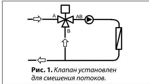
**Рис. 1.** Клапан установлен для смешения потоков.
