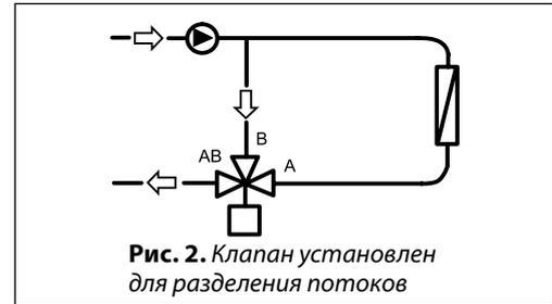
**Рис. 2.** Клапан установлен для разделения потоков
