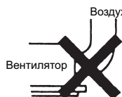
При установке сиффона его не нужно расширять около соединения
