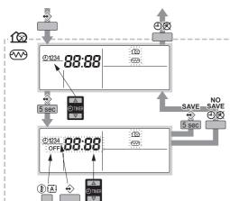
Программирование охлаждения помещения, тихого режима или режима с вспомогательным нагревателем<sup>(1)</sup> выполняется следующим образом:
