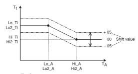
Т<sub>t</sub> Заданная температура воды Т<sub>A</sub> Окружающая (наружная) температура Shift value Значение сдвига
