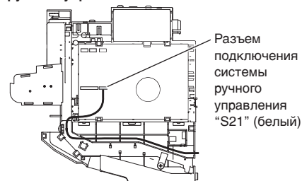
Прокладка соединительного шнура ручного управления
