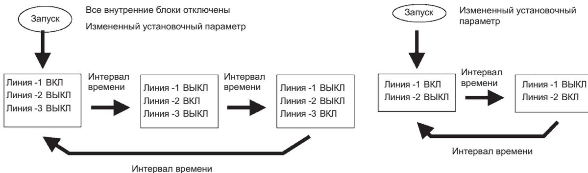
Схема работы в случае, когда количество подсоединенных кондиционеров равно 3, а гарантированный минимум работающих блоков равен 2.
