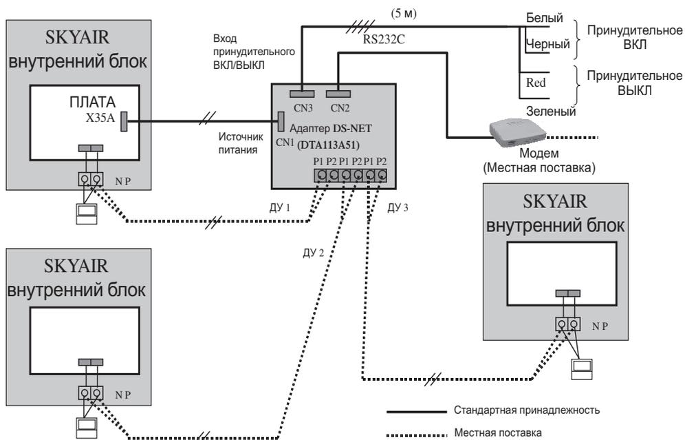
К одному адаптеру могут быть подсоединены до трех линий дистанционного управления, поэтому до трех кондиционеров могут контролироваться и управляться, как показано на рисунке.
