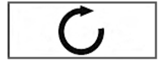
электронасосы с направлением вращения по часовой стрелке, глядя со стороны нагнетательного отверстия
