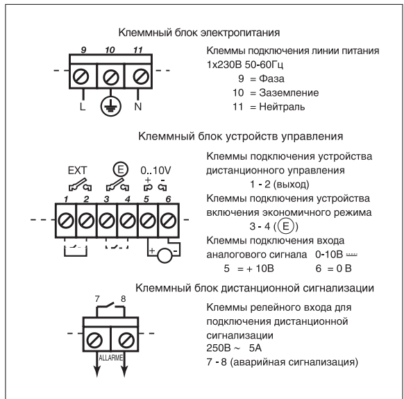
Клеммные соединения в электронном модуле
