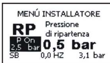
Рисунок 13: Настройка давления нового включения
