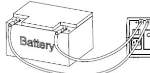
Необходимо заряжать аккумулятор не менее 8 часов для обеспечения работы в течение эксплуатационного срока. Для зарядки аккумулятора, просто включите устройство в розетку. Аккумуляторы будут заряжаться даже если устройство выключено.
