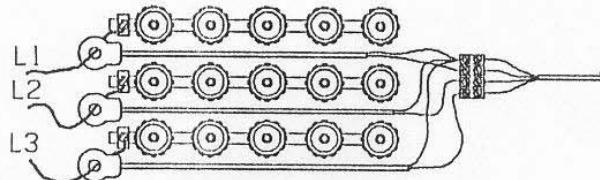
Три датчика тока, по одному на каждую фазу, устанавливаются в электроцентрали следующим образом. Фазы счетчика отсоединяются от соответствующей шины. Провести отдельные кабели через датчики тока, а затем закрепить нашине.
