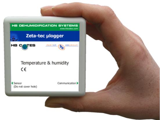
Компактный универсальный регистратор  $\mu$ LOGGER предназначен для регистрации основных параметров воздуха в осушаемом помещении. Он состоит из:
