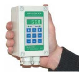
Высокоточный гигростат промышленного применения Air Man предназначен для управления процессом осущения и/или увлажнения. Контроллер состоит из электронного блока Air Man и датчика влажности SmartSens 3000 с кабелем. Алгоритм управления основан на замере относительной влажности датчиком с последующим сравнением замеренных или расчетных (точка росы) данных с заданной уставкой. Программирование контролера осуществляется посредством простой и удобной клавиатуры.
