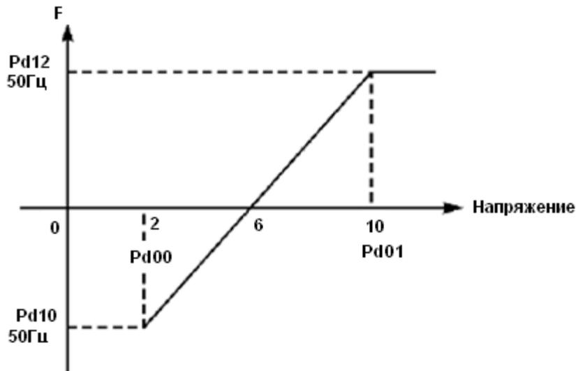
Примечание: P300=2, минимальное входное напряжение на входе FIV: 2 В (сигнал с напряжением ниже 2 В считается равным нулю);
