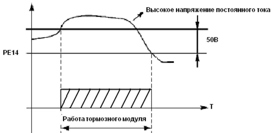
происходит уменьшение напряжения звена постоянного тока и тормозной модуль выключается.
