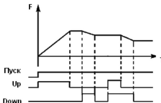
Пояснение: когда действует функция UP (соответствующий контакт замкнут), происходит увеличение частоты. Когда действует функция DOWN, (соответствующий контакт замкнут), происходит
