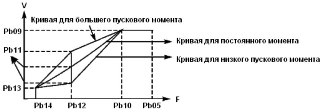
**P109:** V,F-кривая: максимальное напряжение. Максимальное напряжение должно быть установлено в соответствии с моделью двигателя. В большинстве случаев это номинальное напряжение двигателя, но когда двигатель находится в пределах 30 м от контроллер, следует установить немного большее значение.
