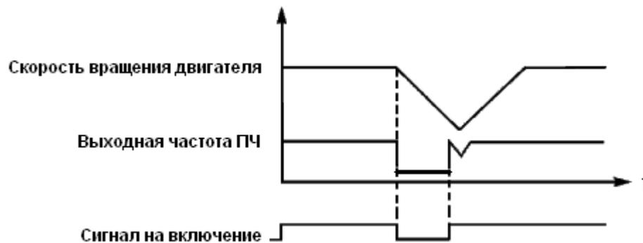
Внимание: во время запуска с поиском частоты контроллер начинает поиск частоты с верхней границы до нижней границы частоты. Это может привести к возникновению перегрузки по току, поэтому необходимо правильно выбрать уровень перегрузки по току (параметр P409) в зависимости от нагрузки.
