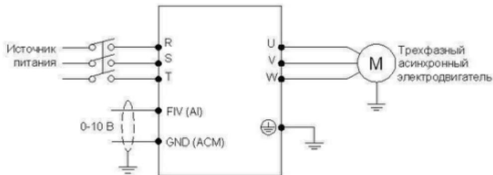
Аналоговое напряжение 0-10В можно сформировать внешним потенциометром 10кОм. Изменение частоты происходит при изменении напряжения от 0 до 10В между клеммами FIV,AI и GND,ACM.
