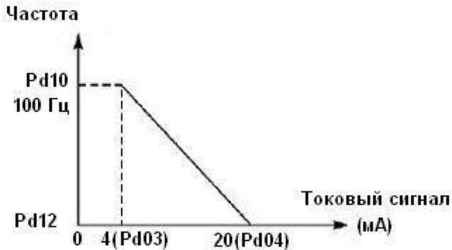
Параметр: P303= 4 Минимальный входной ток на входе FIC P304=20 Максимальный входной ток на входе FIC
