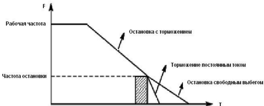
Когда торможение постоянным током неактивно, контроллер уменьшает частоту вращения до тех пор, пока не будет достигнута частота остановки; контроллер прекращает вывод частоты и двигатель свободно вращается до полной остановки.
