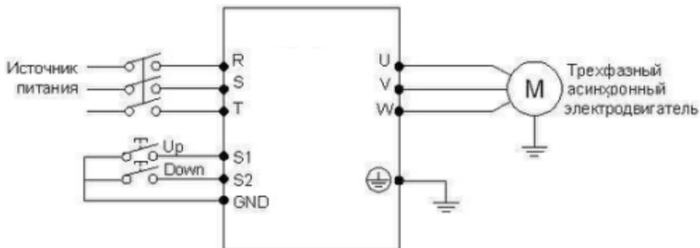
Параметр: P317=15, (программируемому входу S1 присвоена функция UP). P318=16, (программируемому входу S2 присвоена функция DOWN).
