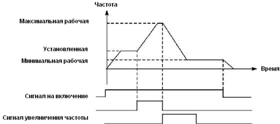
Внимание: по умолчанию изменения частоты, выполненные с помощью команд «UP» и «DOWN» не будут сохранены в памяти перед выключением контроллера, и при последующем запуске частота будет установлена в соответствии со значением параметра P100. (См. также P435)
