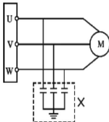
Запрещается подсоединять сглаживающие конденсаторы или иной блок с емкостным сопротивлением к выходным клеммам!
