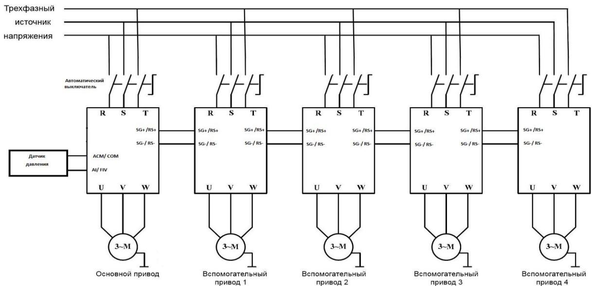
Принципиальная схема подключения контроллеров в многоприводной насосной станции
