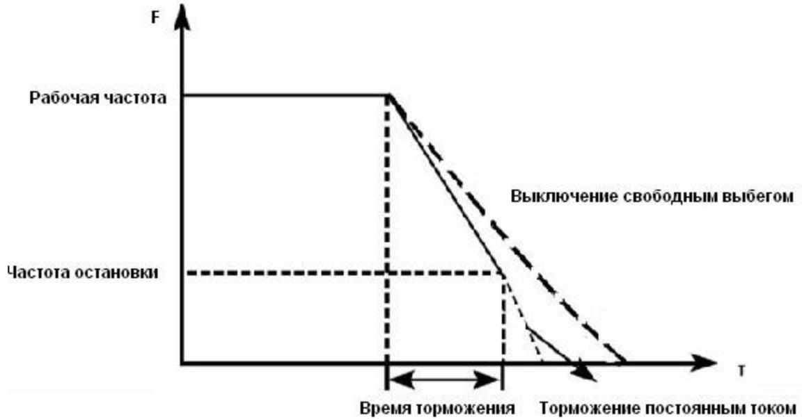
Вместе с выбором режима остановки необходимо определить целесообразность торможения постоянным током на завершающем этапе движения. При этом следует установить величину постоянного тока при торможении, время замедления постоянным током (отличное от нуля) и другие параметры, в противном случае в конце торможения остановка будет происходить в режиме свободного выбега.
