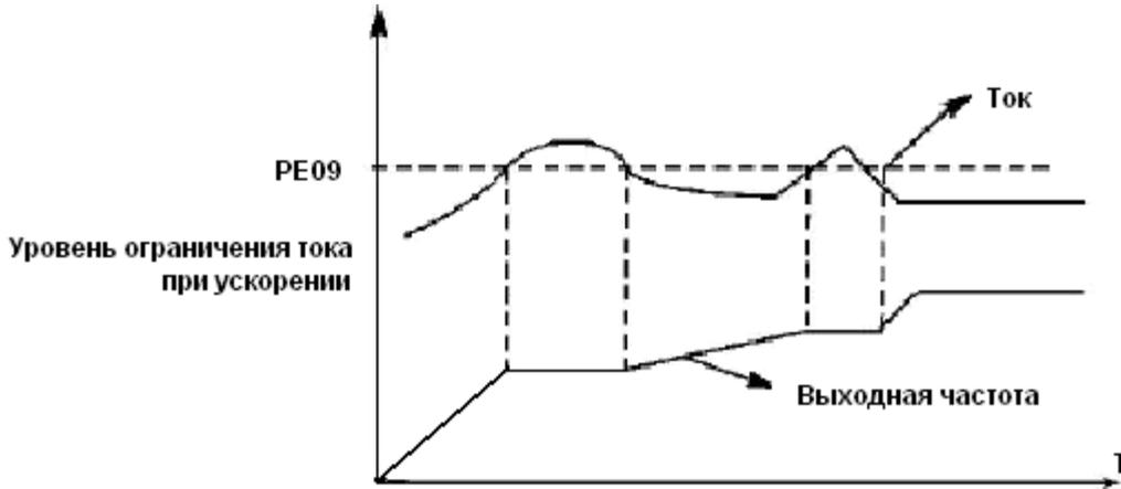
Величина тока перегрузки 100% соответствует номинальному току контроллер (т.е. предельно возможной величине параметра P210 в диапазоне допустимых значений). Защита отключена при P409=0.
