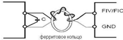
Схема подключения двухпроводного датчика давления 4...20мА с питанием 24 В постоянного тока с фильтрацией сигнала
