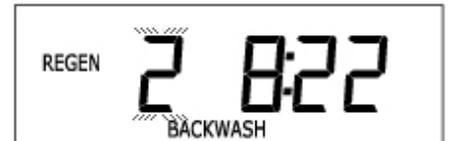
В начале регенерации системы дисплей перейдет в режим отображения информации о текущей стадии режима *Регенерации* и времени до ее окончания. Система автоматически проходит все стадии Регенерации и перенастроится на подачу очищенной воды после завершения Регенерации.
