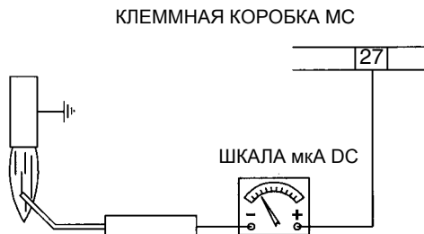
Рис. 30 - Контроль пламени с помощью электрода
