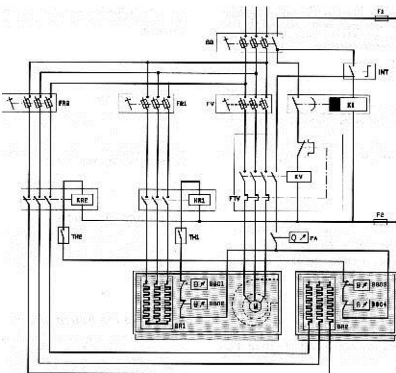
**Примечание: повторно затянуть места подключений через 48 часов работы.**
