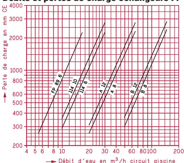
Pour limiter les phénomènes de corrosion et d'érosion, il est impératif de bien respecter les débits d'eau du circuit piscine :
