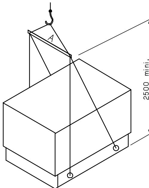
Schéma donné à titre informatif. Dans tous les cas se rapporter aux pictogrammes situés sur l'appareil et plans fournis dans le dossier appareil.
