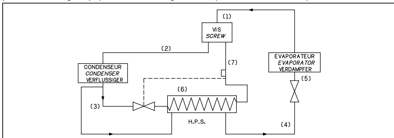
Une faible partie du liquide HP (3) sortant du condenseur est détendue vers un échangeur à une pression intermédiaire. Cette pression correspond à la pression de la connexion H.P.S. sur le compresseur.
