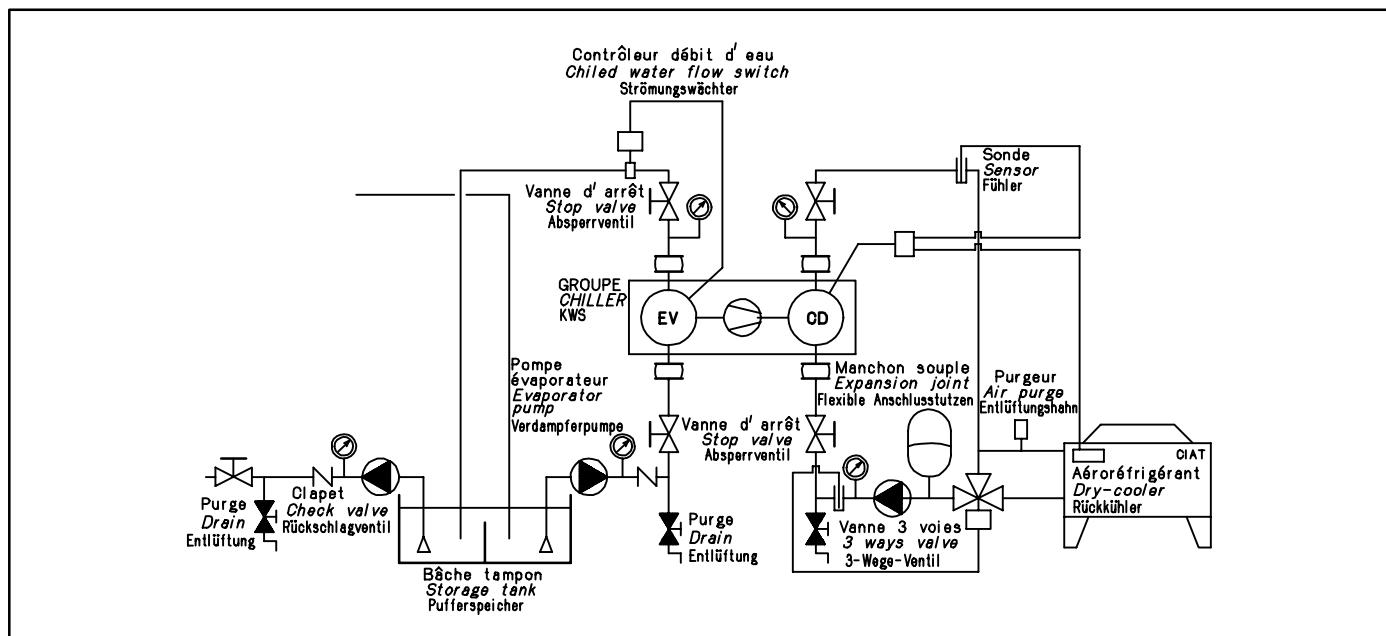
**NOTA :** Une température de 24 °C mini en sortie d'eau condenseur est suffisante pour assurer les démarrages.
