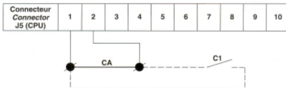
Отключить параллельную цепь СА между клеммами установки (см. электросхему) и подсоединить контакт «С1» к этим клеммам (неполярный и высококачественный контакт).
