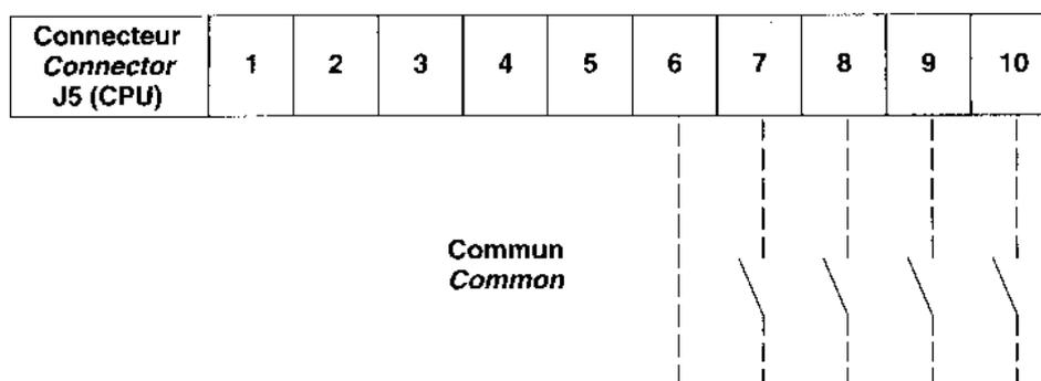
Подсоединить контакты с 1 по 4 к клеммам 6-7-8-9-10 разъема J5 платы центрального процессора в зависимости от количества компрессоров, которые необходимо разгрузить, один контакт на компрессор (неполярный и высококачественный контакт).
