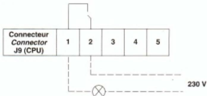
Подсоединить сигнализатор установки, работающей на максимальной мощности к 1 и 2 клеммам разъема платы центрального процессора J9.
