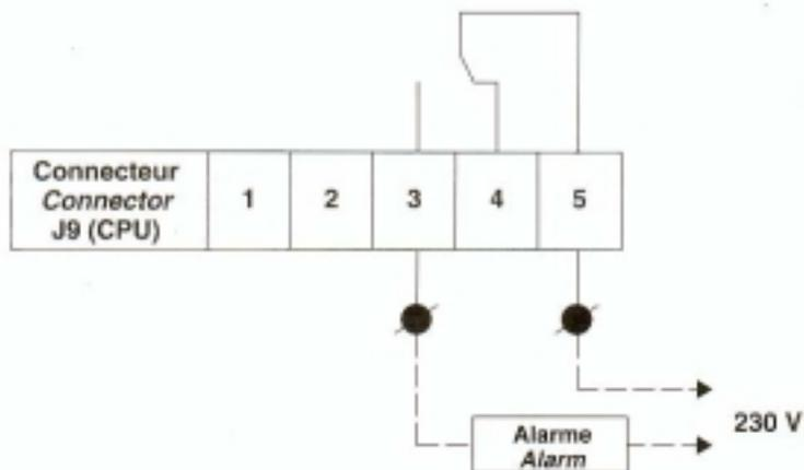
Подсоединить индикатор или сигнализатор (аварийный сигнал) общей неисправности установки к клеммам клеммной колодки установки (см. электросхему).
