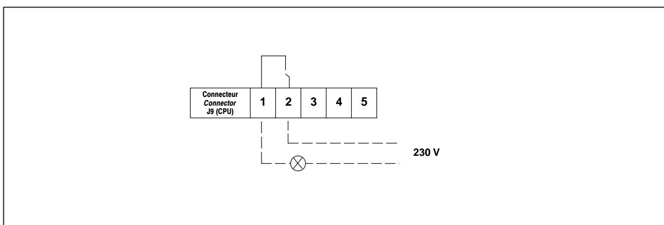
Raccorder la signalisation de fonctionnement du groupe en puissance maxi sur les bornes 1 et 2 du connecteur J9 de la carte CPU.
