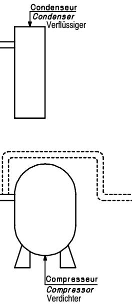
– Das Wasserdruckventil an die Wasseraustrittsleitung des Verflüssigers anschließen (Durchflußrichtung im Ventil beachten).
