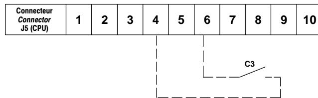
Raccorder un contact " C3 " sur les bornes 4 et 6 du connecteur J5 de la carte CPU (contact libre de toute polarité et de bonne qualité)
