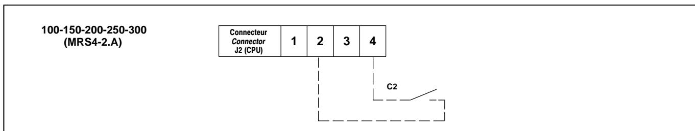
Raccorder un contact " C2 " sur les bornes 2 et 4 du connecteur J2 de la carte CPU (contact libre de toute polarité et de bonne qualité)
