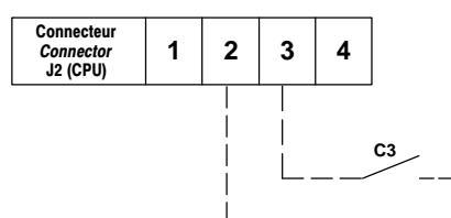
Raccorder un contact " C3 " sur les bornes 2 et 3 du connecteur J2 de la carte CPU (contact libre de toute polarité et de bonne qualité)
