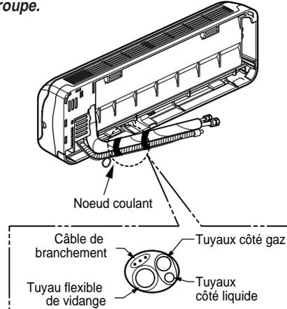
**Remarque :** Si le tuyau flexible de vidange passe à l'intérieur de la pièce, isolez le tuyau avec du matériel isolant\* pour que les gouttes éventuelles de condensation ne provoquent pas de dommages aux meubles et au plancher.
