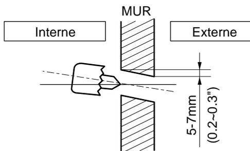
**B** Mesurez la paroi et marquez la ligne centrale. Il est important de faire très attention pour l'emplacement du plateau d'installation, d'habitude les fils électriques passent à travers les parois. Les trous pratiqués dans le mur pour le branchement des tuyaux doivent être effectués en faisant très attention.
