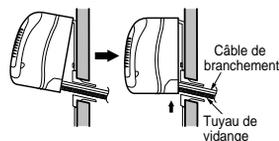
Appuyez sur le côté inférieur droit et gauche du groupe contre le plateau d'installation jusqu'à ce que les crochets soient insérés dans leurs logements (on entend le bruit de l'enclenchement).
