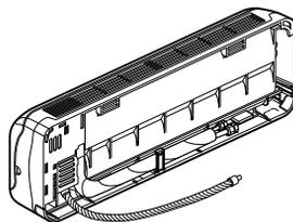
2. Introduisez les tuyaux, le tuyau flexible de vidange et de câble de branchement dans le trou pour les tuyaux.
