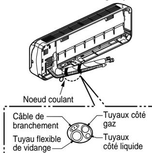
**Remarque :** Si le tuyau flexible de vidange passe à l'intérieur de la pièce, isolez le tuyau avec du matériel isolant\* pour que les gouttes éventuelles de condensation ne provoquent pas de dommages aux meubles et au plancher.
