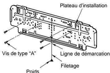
2. **Mesurez la paroi et marquez la ligne centrale. Il est important de faire très attention pour l'emplacement du plateau d'installation, d'habitude les fils électriques passent à travers les parois. Les trous pratiqués dans le mur pour le branchement des tuyaux doivent être effectués en faisant très attention.**
