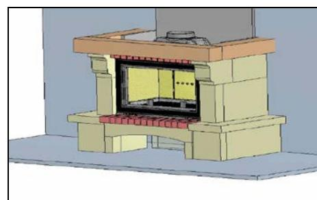
**Необходимо защитить балку либо при помощи изоляционного негорючего материала или материала класса огнестойкости не менее А2-s1, d0, либо за счет дефлектора или фронтона.**
