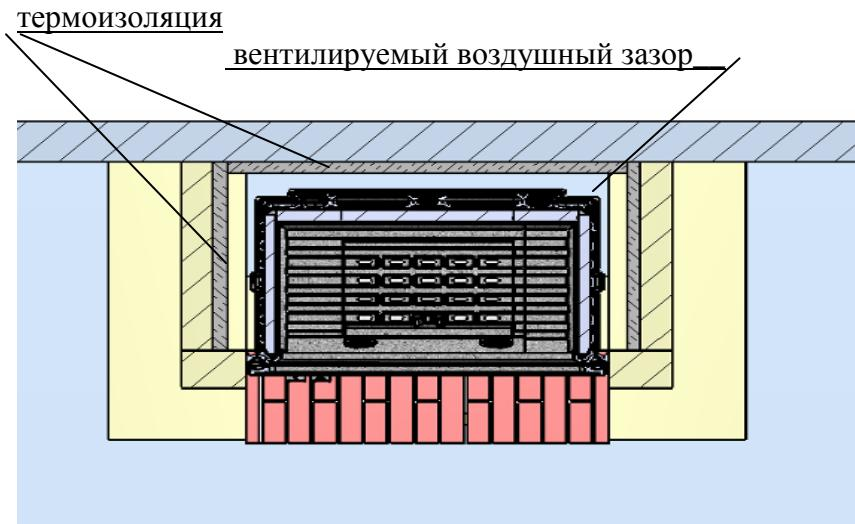
Защита перегородки из негорючих материалов теплоизоляционным материалом класса A1 или не менее A2 s1 d0.
