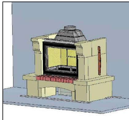
Установить элементы с помощью цементного клея (например, клея для гипсовой плитки).
