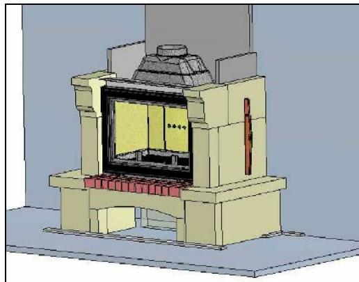
**Типовой пример изоляции опорного основания и стены прилегания топки с помощью минераловатных панелей толщиной 30 мм.**
