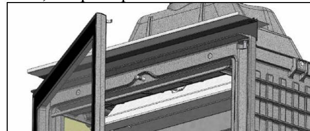
**Механизм регулировки тяговой заслонки: открытое
