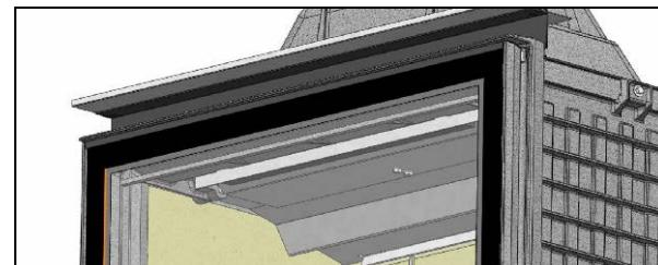
**Механизм регулировки тяговой заслонки: закрытое
