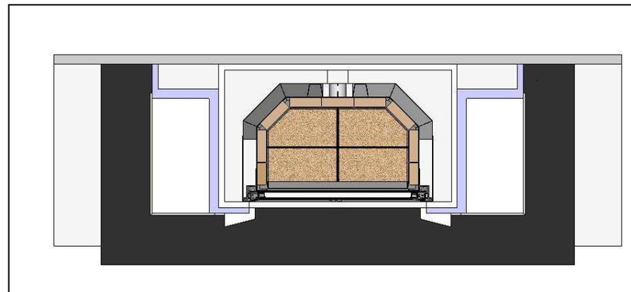
Защита перегородки из негорючих материалов теплоизоляционным материалом класса A1 или не менее A2 s1 d0.
